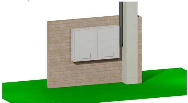
Vista posterior com eletroduto exposto instalado na face lateral do poste e com entrada pelo fundo da caixa.
